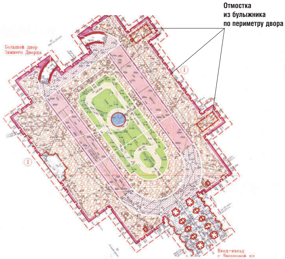
Рис. 49. Проект булыжного мощения отмостки Большого двора Зимнего дворца с применением растворов.
