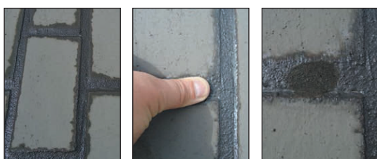
Рис. 27. Определение времени до начала очистки для водонепроницаемых растворов. Тест “большого пальца”. Раствор начал схватываться - можно приступить к очистке.
